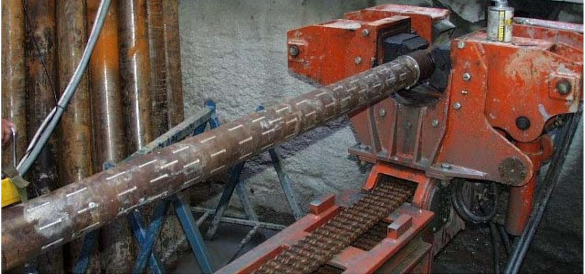
В течение 12 часов весь защитный материал растворяется, и поток воды устремляется по обсадной трубе.
